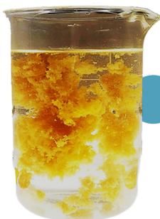
El segundo paso **La floculación** mediante un proceso mecánico de **agitación Lenta**, aglutina los coágulos facilitando su decantación y posterior filtrado. Es promovida por el gradiente de velocidad y el tiempo dos (2) factores importantes que aumentan la probabilidad de que las partículas se aglomeren y da tiempo para que decanten por efecto de gravedad acumulándose en el fondo.
